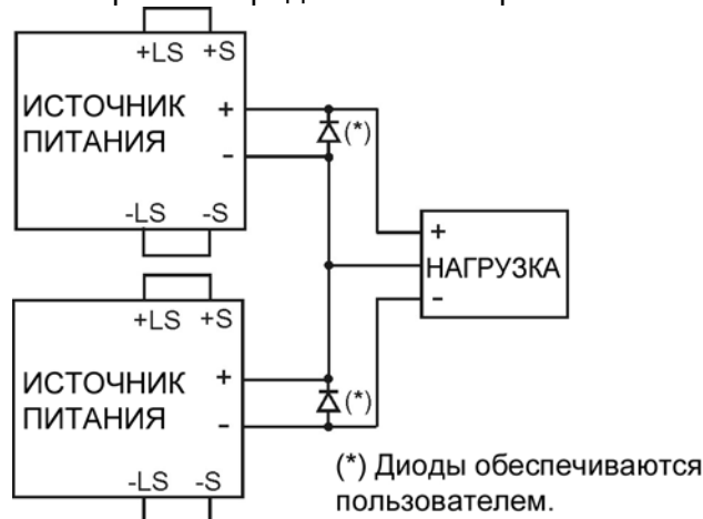
Рис.5-3: Последовательное соединение для получения положительного/отрицательного выходного напряжения
