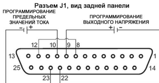
Рис.6-1: Подсоединение внешнего программирования уровнями напряжений
