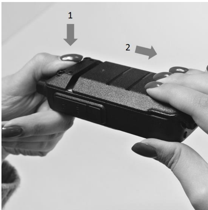
Рис. 3. Снятие аккумуляторной батареи.
