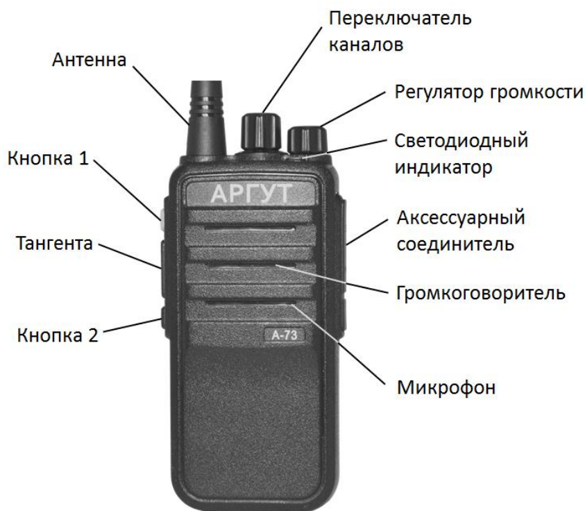
Рис. 1. Расположение органов управления, индикации и соединителей.
