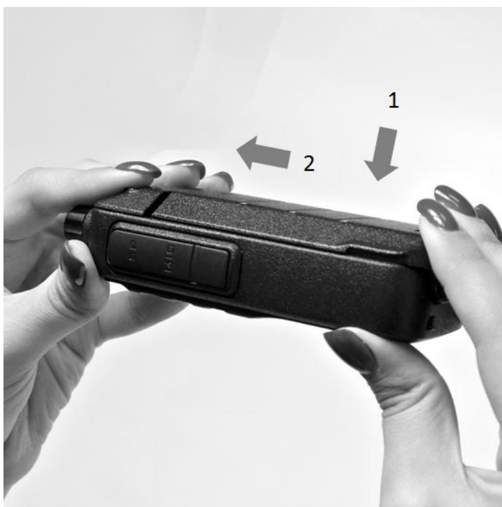
Рис. 2. Установка аккумуляторной батареи.
