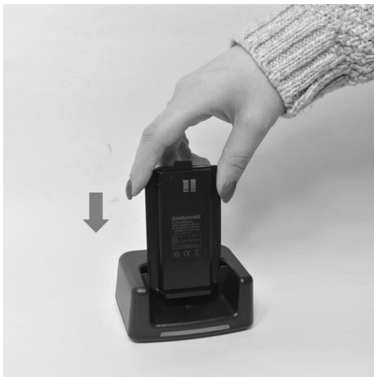
Рис. 7. Установка аккумуляторной батареи на зарядную базу.
