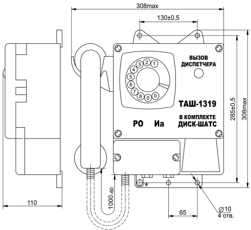
Рисунок 1. Аппарат телефонный шахтный ТАШ-1319.
