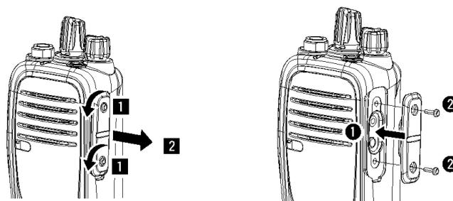
**Примечание:** подключение или отключение дополнительного оборудования следует производить при выключенном питании радиостанции.
