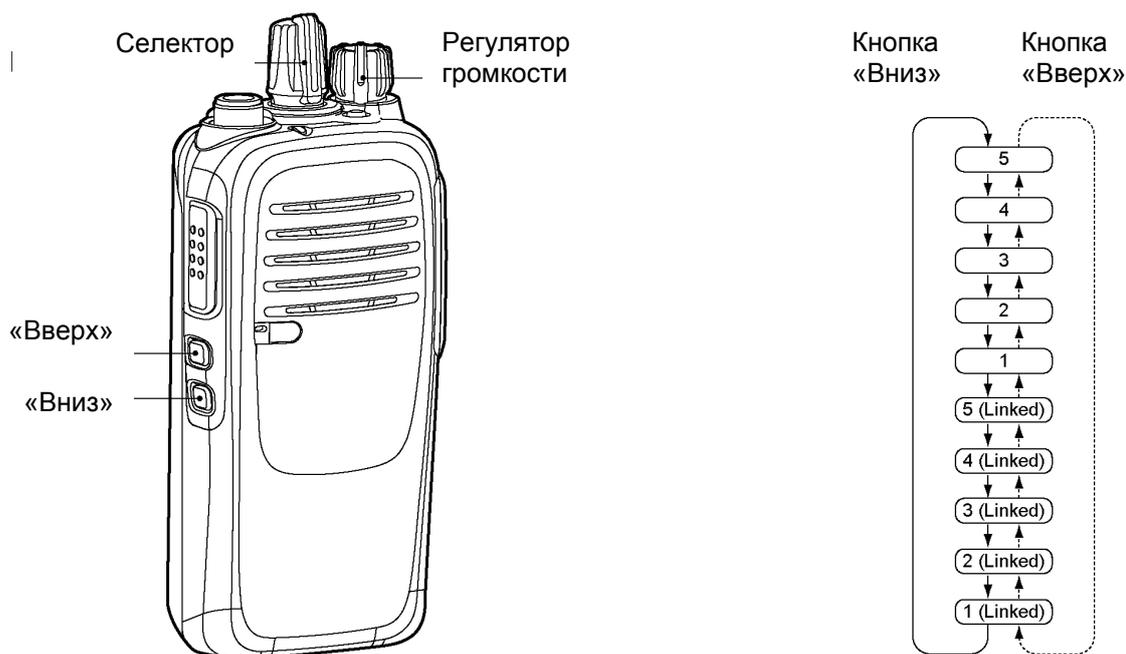
3. Удерживая нажатой кнопку «вниз» поверните ручку регулятора громкости для включения питания радиостанции и входа в режим настройки уровня звука.
